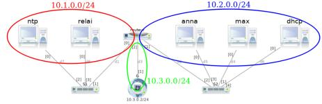
Le réseau est scindé en trois sous-réseaux interconnectés par un routeur.
